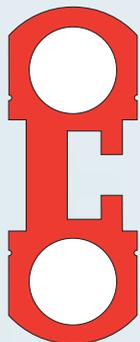
**RAILSCAF®** представляет собой монорельс легкого и компактного профиля, который может оборудоваться встроенной цепью, позволяющей автоматической крановой тележке перемещаться на уклонах до 60°. Такое решение особенно эффективно в комплекте с люльками SOLO.
