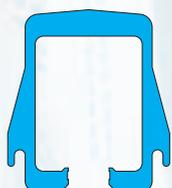
**ORAIL** представляет собой горизонтальный монорельс U-образного профиля, который может устанавливаться внутри утепленной части здания или на декоративных элементах. Система исключительно высокой эстетики. Поперечно перемещающаяся тележка скользит внутри монорельса, скрывающего эту надежную подвесную установку.
